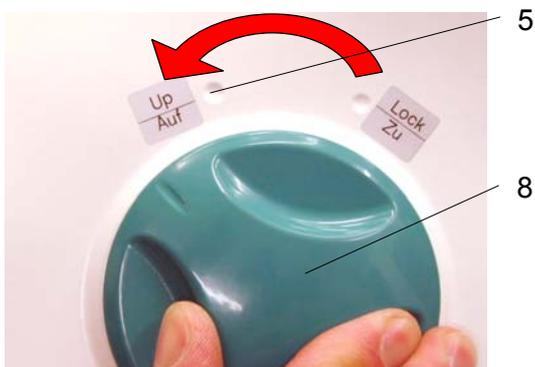
Den Drehverschluss **8** über die Markierung **5** bis zum Anschlag nach links drehen und festhalten.
